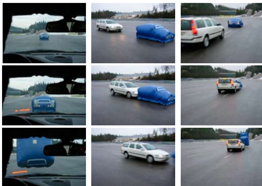
Figur 2: Figuren visar ett test med det av Volvo Cars och LiU utvecklade systemet för kollisionslindring. En radar används som extern sensor och bromsning sker autonomt då alla kollisionssundvikande manövrar kan uteslutas. Eftersom undanstyning är den effektivaste manövern vid hastigheter över 35 km/h så sker ingreppet tämligen sent (notera bromsljus, varningslampa och nigningsvinkel), men kan ändå minska kollisionshastigheten med 15 km/h.
