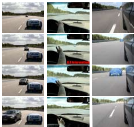
Figur 4: Illustration av det av Volvo Cars och LiU utvecklade systemet för filhållningshjälp. En kamera och en radar håller koll på omgivningen. Kameran övervakar också om bilen korsar de vita filmarkeringarna utan att körriktningvisaren är på, men systemet agerar endast då det föreligger en risk i ett filbyte (statiskt objekt, mötande fordon etc).
