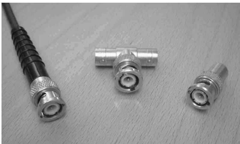
Figur X. Koaxialkontaktdon. Från vänster till höger ser vi BNC-kontakt på koaxialkabel, skarvdon s. k. T-stycke och termineringsdon.
